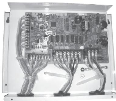
Контроллер PAC-IF021B-E предназначен для управления тепловыми насосами „воздух–вода” полупромышленной серии Mr. Slim. Предусмотрена работа системы по температуре прямой воды (на выходе воды из теплообменника).
