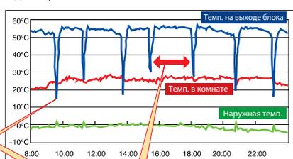
Благодаря специальным алгоритмам управления интервал между режимами оттаивания увеличен до 150 минут (при температуре наружного воздуха  $-20^{\circ}\text{C}$  или  $0^{\circ}\text{C}$ )
