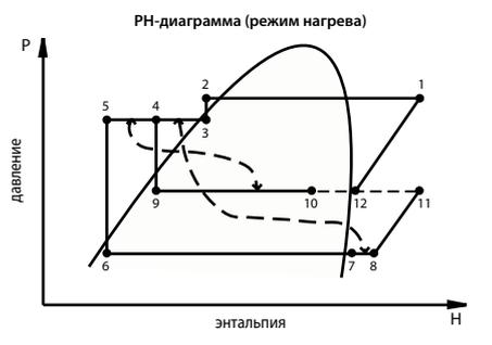
Часть жидкого хладагента, ответвленная от основного потока в цепь инъекции, превращается в парожидкостную смесь среднего давления. При этом температура смеси понижается, и она подается через специальный штуцер инъекции в компрессор.
