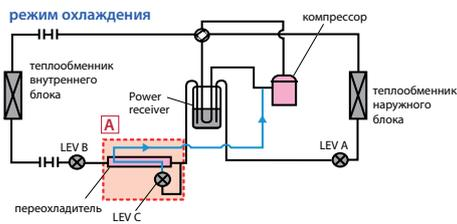
Переохладитель добавлен в гидравлический контур для увеличения энергоэффективности системы в режиме охлаждения. Часть жидкого хладагента испаряется в переохладителе и поступает на вход компрессора, увеличивая давление в линии всасывания. Нагрузка компрессора уменьшается, а энергоэффективность системы увеличивается.
