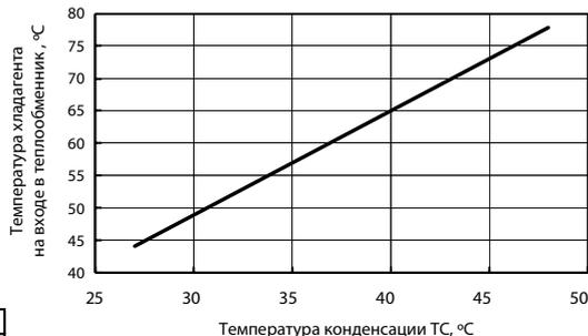
Рис. 2. Зависимость температуры хладагента на входе в теплообменник
