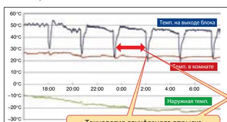
Технология двухфазного впрыска сокращает длительность режима оттаивания с 4 до 3 минут.
