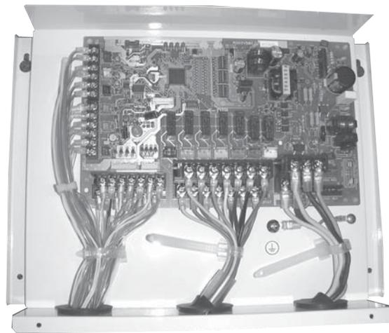
Контроллер РАС-IF011В-Е предназначен для плавного (ступенчатого) управления наружными блоками полупромышленной серии Mr. Slim:
