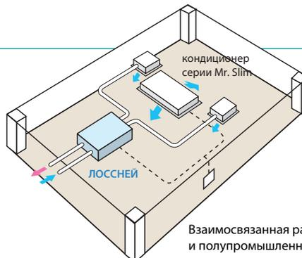
Взаимосвязанная работа вентустановки ЛОССНЕЙ и полупромышленного кондиционера
