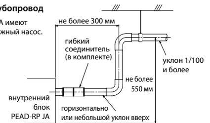
**Схема соединений внутреннего и наружного блоков**
