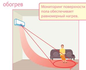
Охлажденный воздух опускается в нижнюю зону помещения, вызывая её чрезмерное охлаждение. Датчик **I SEE** контролирует температуру поверхности пола и при достижении целевого значения уменьшает мощность кондиционера, предотвращая переохлаждение.
