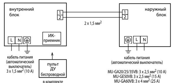
Примечание: кабели электропитания внутреннего и наружного блоков должны быть подключены к одной (общей) фазе!
