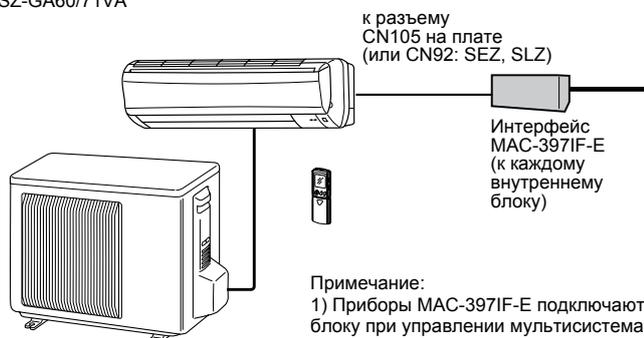
1) Вкл/выкл, блокировка пульта, переключение режима и установка температуры с помощью внешних сухих контактов.
