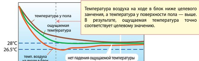
Температура воздуха на входе в блок ниже целевого значения, а температура у поверхности пола — выше. В результате, ощущаемая температура точно соответствует целевому значению.
